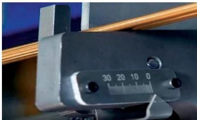
ASSE CONTROLLATO PER IL POSIZIONAMENTO DELLA BARRA
