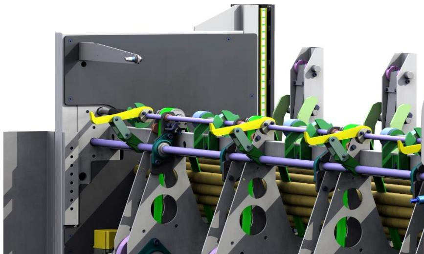
Leve comandate pneumaticamente permettono di depositare dolcemente e senza rumore la barra selezionata dal caricatore da fascio sul magazzino del caricatore alimentato.
